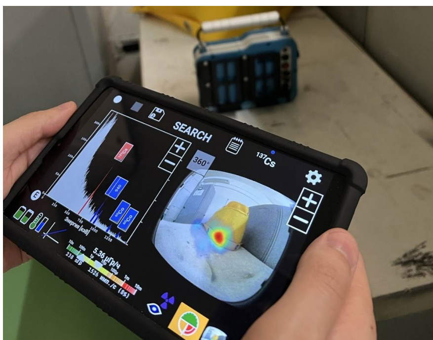
Гамма-спектрометр с функцией визуализации, используемый на ЮУАЭС. Это устройство, приобретенное Агентством за счет внебюджетного взноса Соединенного Королевства, было доставлено на ЮУАЭС 26 мая 2023 года. (Фото: ЮУАЭС)
